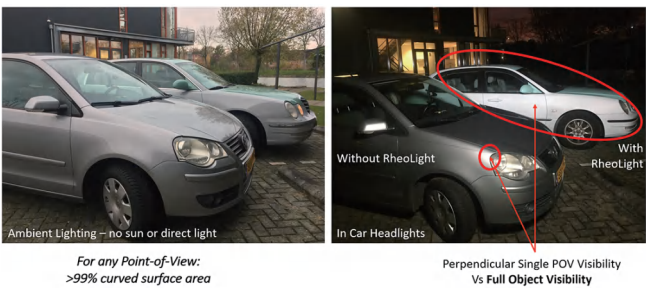
图 8 ❖ 通过在汽车后部的灰色中添加水晶玻璃颜料，增加了灰色的AIPOV可见性，增加了汽车引擎盖等高角度表面在夜间的视角可见性，并提高了车窗周围较细线条的对比度。
