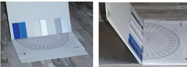
图 7 ❖ 具有聚焦（前照灯和LiDAR）照明的近垂直和高入射角显示出颜色可见性的显著差异。
