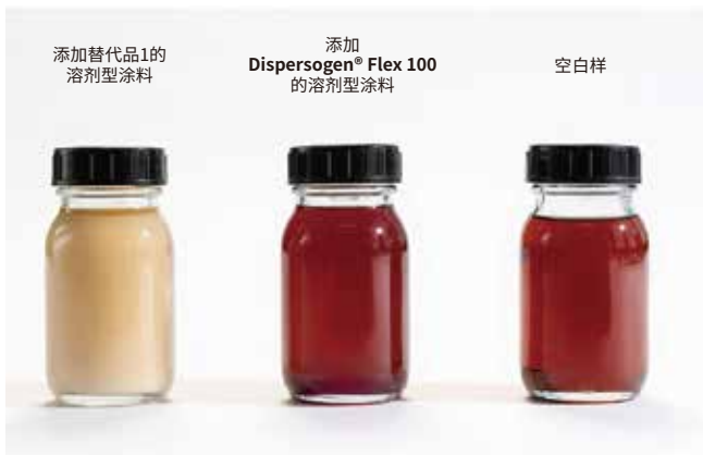
图 5 ❖ 分散剂和溶剂型体系的相容性试验。
