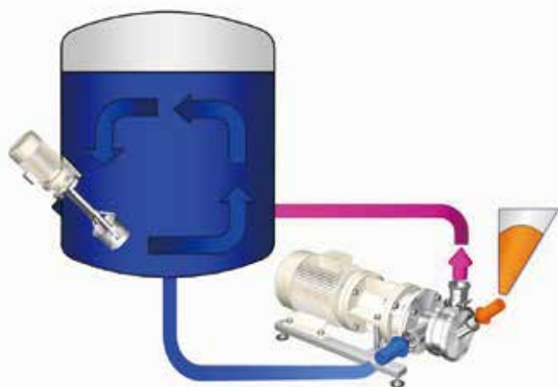
图2 ❖ 带在线分散器的循环工艺和安装有射流混合器的工艺容器。
