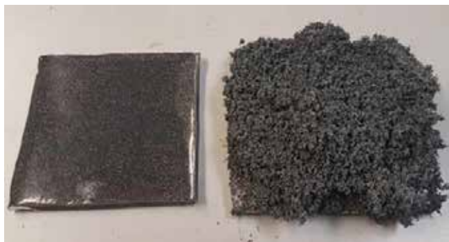
图 2 ❖ 暴露于丙烷火焰之前和之后，钢基材上含有GrafGuard可膨胀石墨的反应性环氧涂层的照片。
