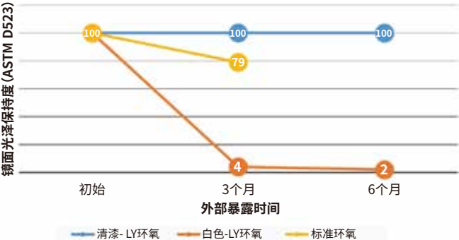
图 8 ❖ 外部老化后的光泽保持率（%）（朝南测试围栏；德克萨斯州休斯顿）。
