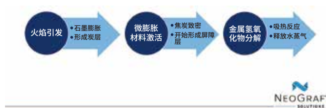
图4 ❖ GrafGuard反应型防火涂料起作用的阶段简化图。
