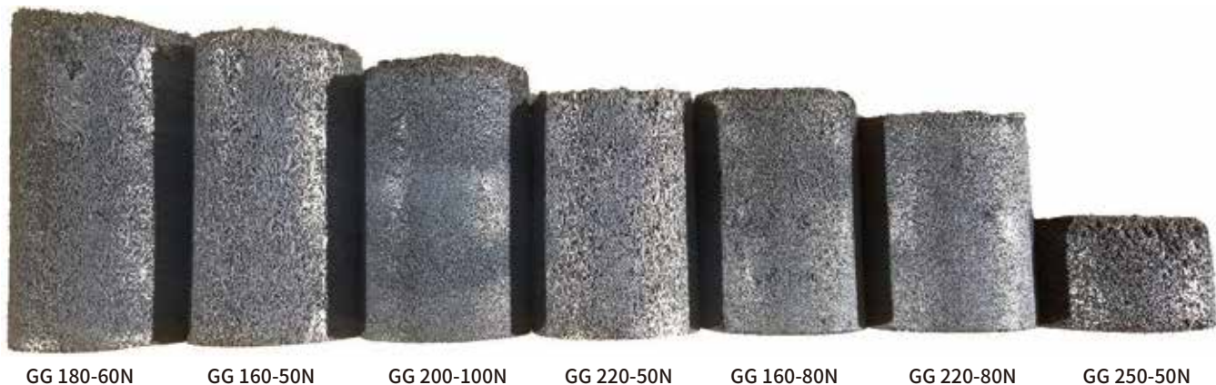
图 3 ❖ 相同温度下，不同等级的GrafGuard材料在标称压力下的封闭圆柱体中膨胀。
