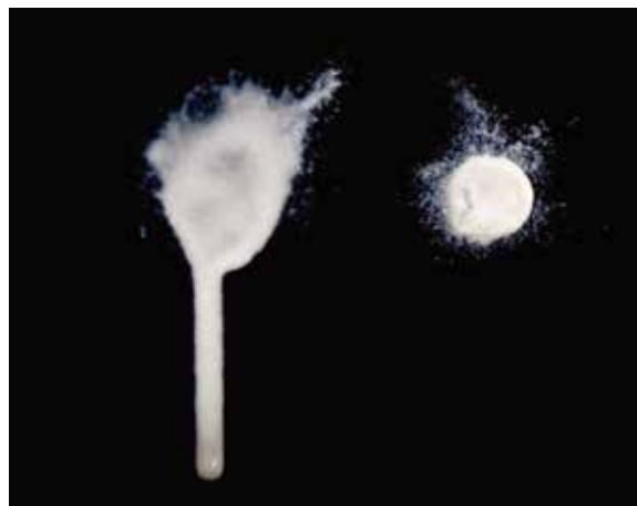
图2 不含MFC (左) 和含MFC (右) 的乳液喷涂时的状态。
