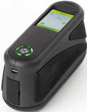
图 8 具有12个测量角度和2个光源接收器MA-T12。
