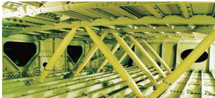
图5 » 飞机机翼内部的燃料箱。
