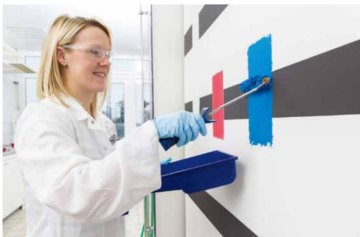
实验室助理在测试涂料的遮盖力。（图片来源：Wacker Chemie AG）
