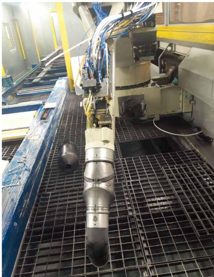
图9 » 机器人面罩示例图。
