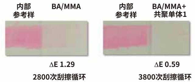
图 5 ❖ 通过选择合适的共聚单体，改善的耐沾污和耐刮擦性能。
