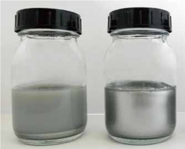
图5 ❖ 不含（左侧）和含有（右侧）新型聚酰胺类流变添加剂的水性双组分聚氨酯铝粉底涂漆的防沉性（铝粉颜料：ECKART Hydrolan IL 2154）。
