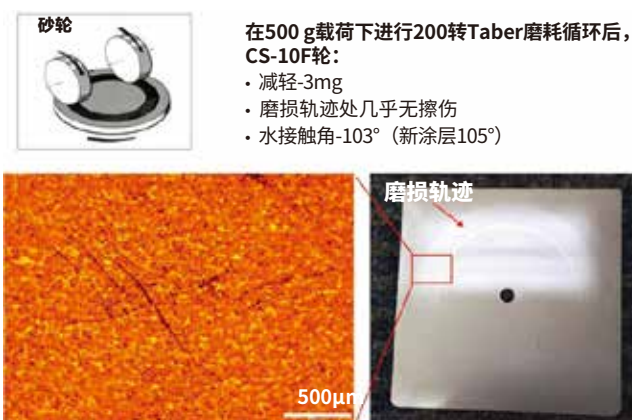
图4 ❖ Taber磨损试验的光学显微照表明，SuperAi涂层具有出色的耐磨性。
