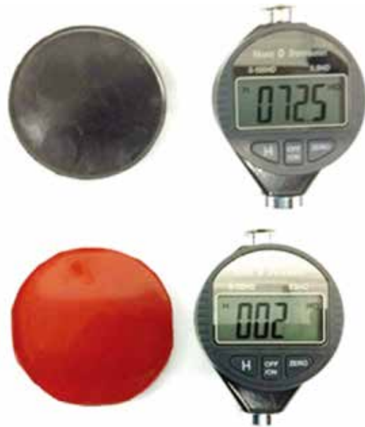
图5 ❖ 比较了两种技术的邵氏硬度 (ASTM D-2240)。
