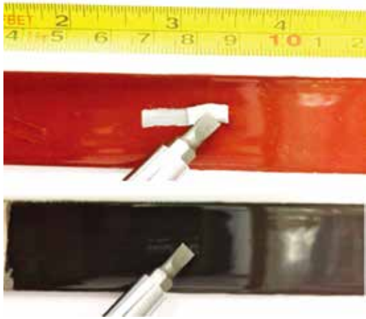
图4 ❖ 使用ASTM D522/D522M - 17附着有机涂料的芯棒弯曲标准试验方法，比较了两种技术。涂层涂覆厚度为 150\mu\text{m} ，弯成8 mm。
