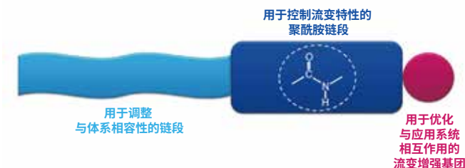
图1 ❖ 新型流变助剂的结构
