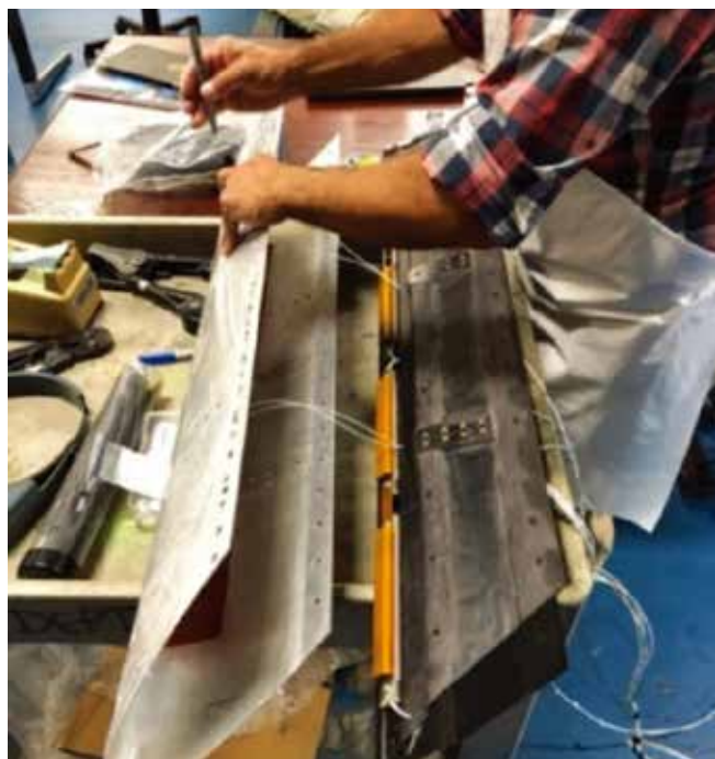
图2 ❖ 装配了热机械除冰系统，涂覆了SuperAi涂层的飞机前缘。
