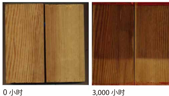
图6 ❖ 含稳定剂的PUR配方在3,000小时老化暴露前后的情况。
