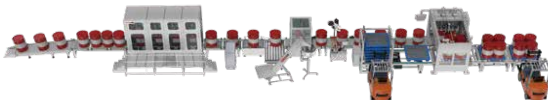
200L全自动液态产品包装生产线 开盖、灌装、旋盖三位一体
