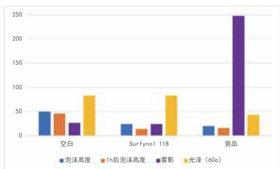
图4 不同助剂（1%）在水性色漆中的控泡性能及相容性（光泽/雾影）
