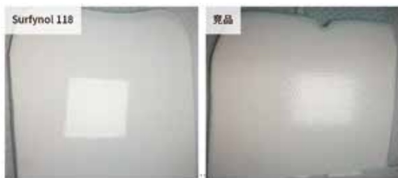
图3 不同助剂在水性汽车色漆漆膜中的相容性（干膜膜厚40um，助剂用量1%）
