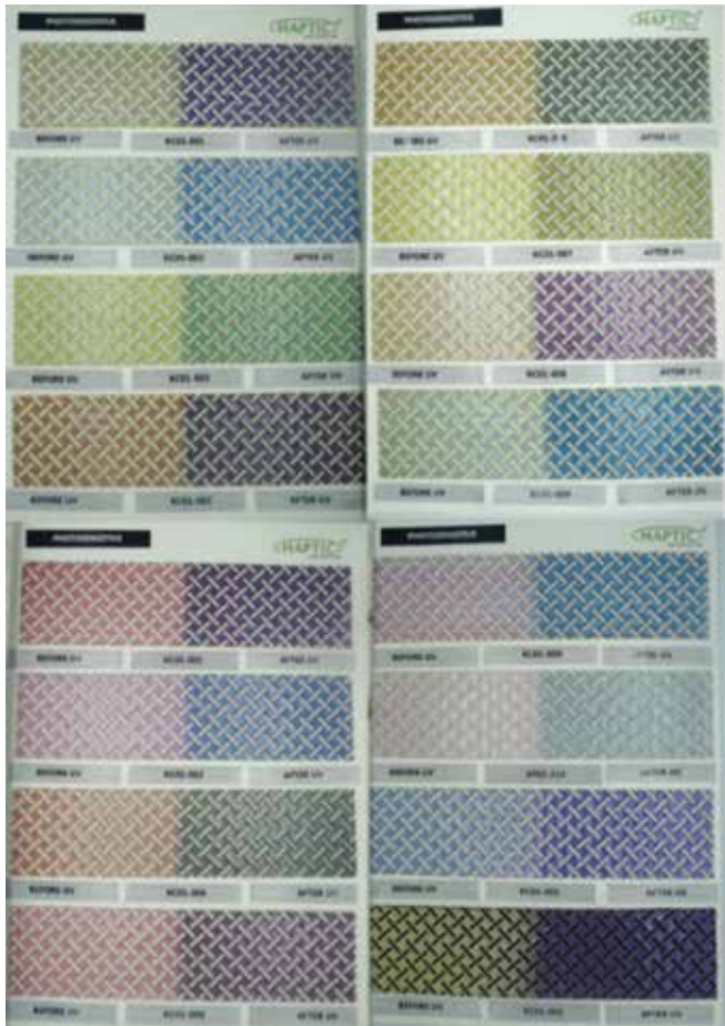
图 4 ❖ 光敏触感涂层在紫外线照射前后的颜色汇总图。
