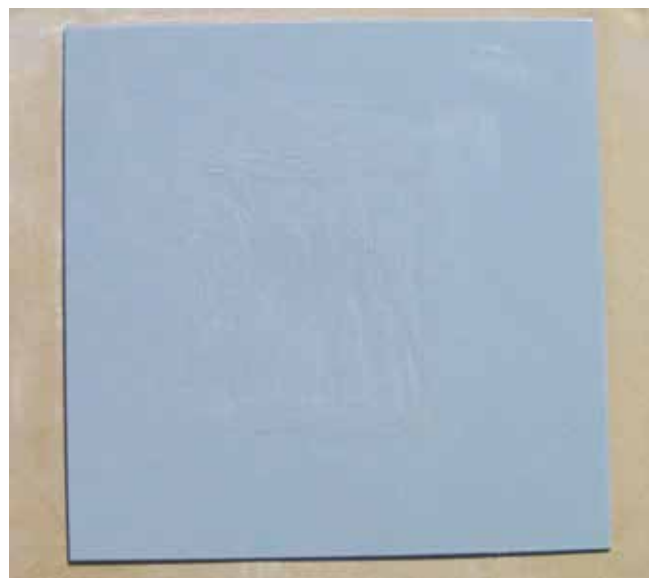
图 12 ❖ 用热固化2K环氧涂料修复涂层。
