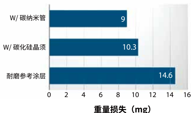
图 9 ❖ 含碳化硅晶须或碳纳米管涂层的耐磨性 (mg/1000 次循环)。
