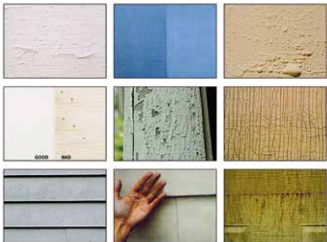
图1 ❖ 涂料不同类型的表面缺陷。
