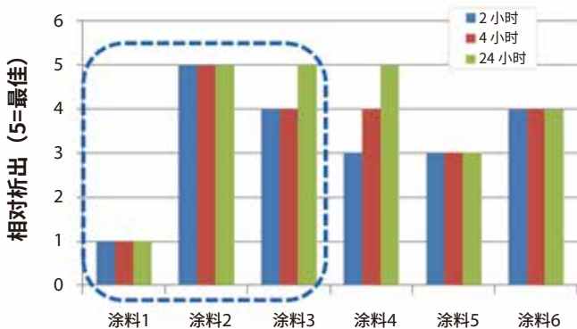
图 13 ❖ 粘结剂和配方对表面活性剂析出的影响。
