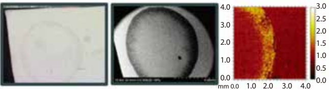
图 5 ❖ 左图：一滴水蒸发后涂层表面的光学图像。中间：光学图像的扫描电子显微照片突出显示了液滴边缘附近的有机物浓度（暗区）。右图：通过TOF-SIMS对液滴的2D分子表示，显示了液滴边缘渗出物的富集。
